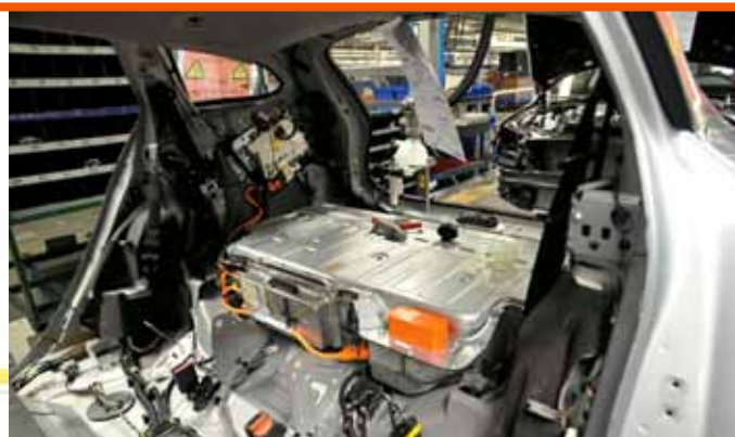
Det 140 kilo tunga batteripaketet i V60 Plug-in-Hybrid består av litiumjonbatterier med ett energiinnehåll på 11,2 kWh. Batteripaketet lyfts in genom bakluckan och placeras över bakaxeln av krocksäkerhetsskäl.
