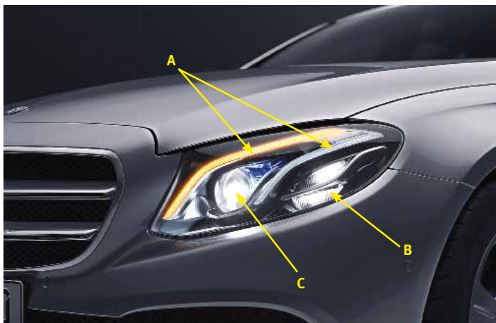
Frambelysning Mercedes. Varselljus som också används som blinkers (A). Rörlig halv-ljusmodul (B). HELLJUSMODUL baserad på lys-diodsmatrix (C).
