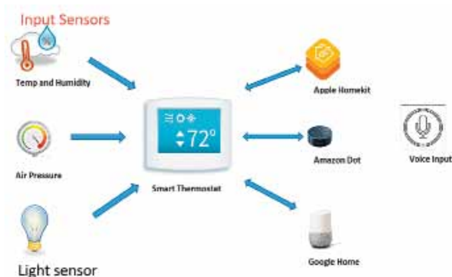
Figur 1. Framtida hemtermostater kommer att stödja flera kommunikationsgränssnitt, både en- och tvåvägs.
