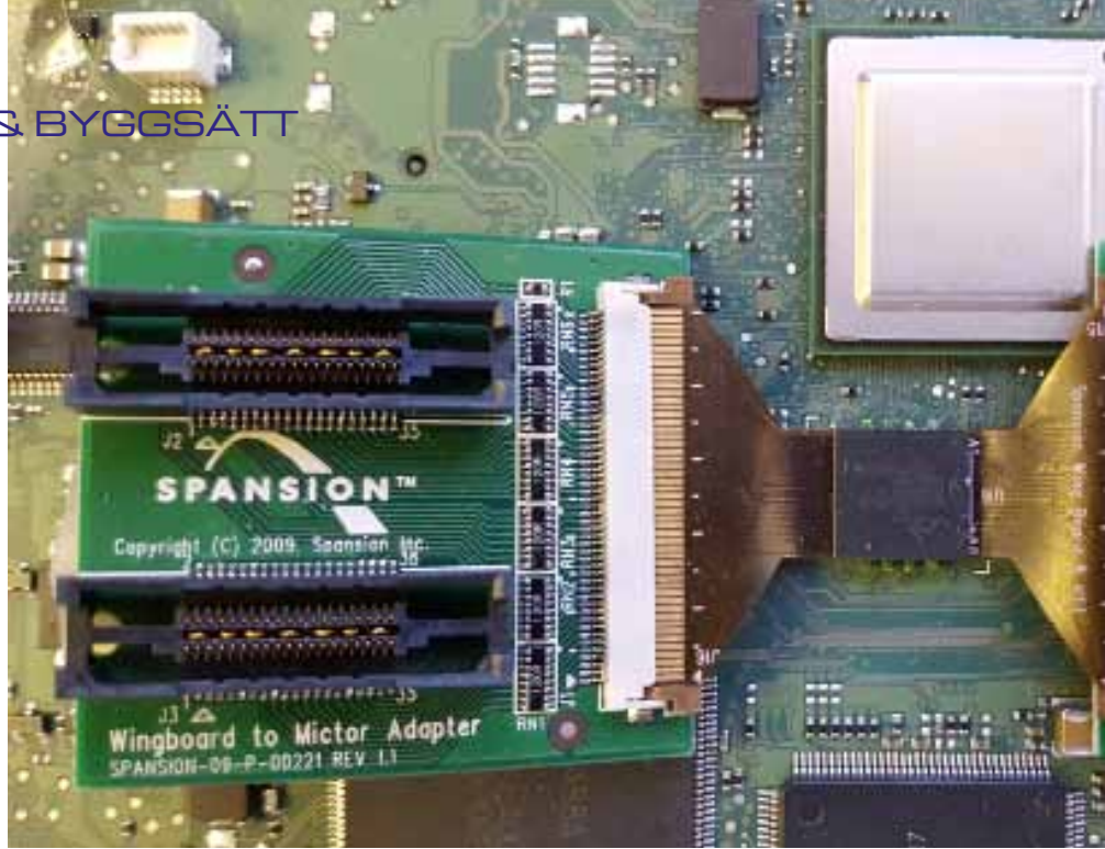
Bild 2. Wingboard monterat på en testkort. Wingboard-konceptet utvecklades av Spansion, innan företaget köptes av Cypress.
